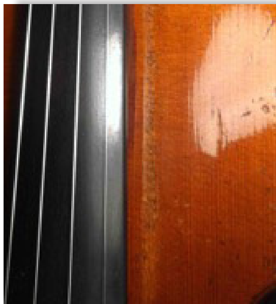
Ilustración 8. Marcas producidas con la uña del pulgar derecho al tocar en pizzicato . La repetición de este gesto acaba provocando un surco en la superficie de la tapa.
