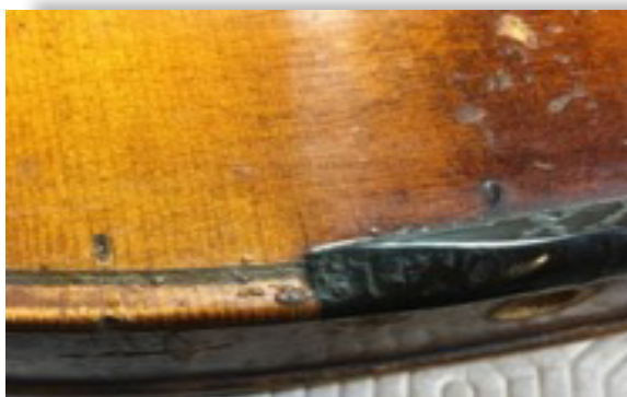
Ilustración 4. La cejilla de ébano no permite que la madera de abeto pueda mermar naturalmente produciéndose una grieta.
