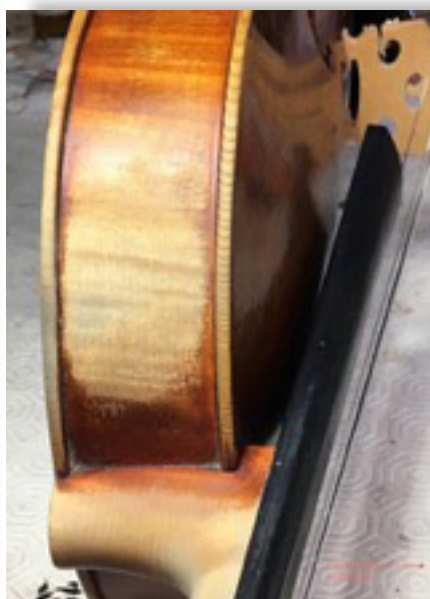
Ilustración 9. Desgastes por uso en zonas de contacto con la piel del músico, y también por efecto de la humedad y acidez de la transpiración.
