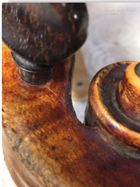
Ilustración 14. Grieta producida por una clavija mal ajustada en una cabeza de violín.
