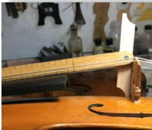
Ilustración 27. Herramienta o plantilla para comprobar la proyección periódicamente.
